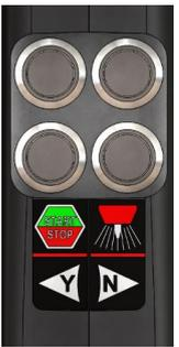
**4 boutons de télécommande en inox** : Start/stop, déclenchement de la purge gaz, rotation du rotor dans un sens et rotation dans l'autre sens.
