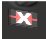
Wenn die Stromquelle eingeschaltet und die Zange angeschlossen ist, leuchtet das Logo. Wenn die Maschine schweißt, blinkt das Logo.
