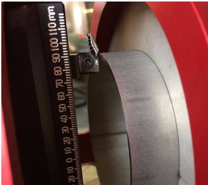
Especialmente indicadas para tubos de diámetros cortos de <math><25,4\text{ mm}</math> ya que a menudo se cortan con un cortatubos, a mano o con abrasivos. En todas estas situaciones deberá realizarse un refrentado antes de soldadura para obtener soldaduras de calidad.
