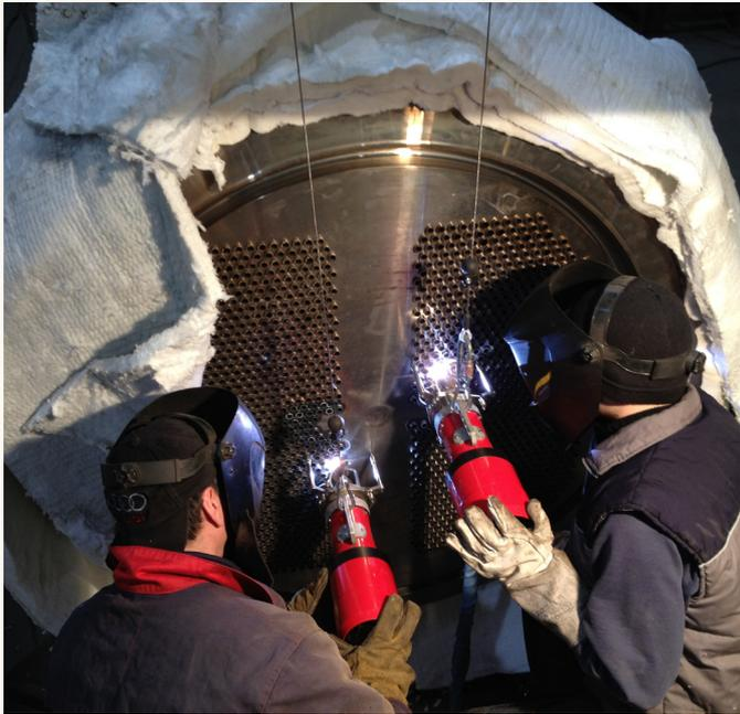
Dans les applications tubes sur plaque, la préparation est un aspect très important pour permettre de garantir un résultat de soudure répétitif et de qualité. Les étapes suivantes sont à discuter à chaque projet et sont primordiales pour assurer le succès de votre process:
